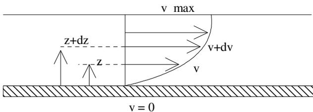
Si on représente par un vecteur la vitesse de chaque particule située dans une section droite perpendiculaire à l'écoulement d'ensemble, la courbe lieu des extrémités de ces vecteurs représente le profil de vitesse.
