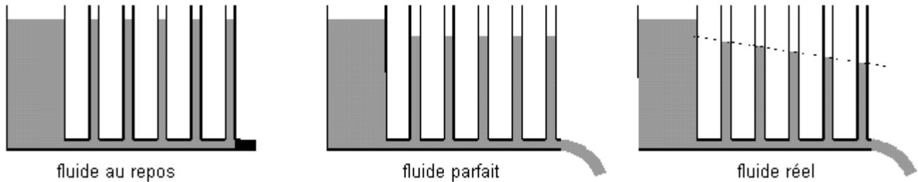
Pour un écoulement permanent et laminaire, dans une conduite cylindrique horizontale, de longueur  $L$ , de rayon  $R$ , le débit volumique  $D_V$  du fluide est donné par **la loi de Poiseuille** :
