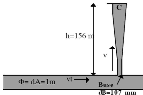
En négligeant les pertes par frottement et à partir d'une hypothèse quant à la vitesse en A (amont du tube) et en supposant que  $P_B = P_C = 1 \text{ atm}$ , calculer :
